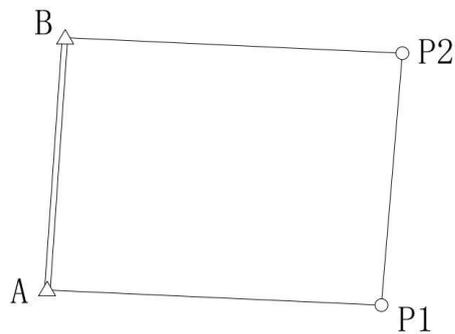
图 2 一级、二级导线测量竞赛路线示意图
